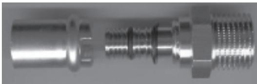
Fig. 2 : Raccord à sertir : Pour des raisons de clarté le manchon à sertir, solidaire du raccord, est montré séparément.
