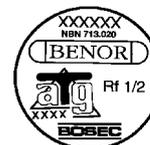
Elle est encadrée en usine par le fabricant dans la moitié supérieure du chant du vantail, côté fermeture.
