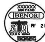
Cette marque est apposée en usine par le fabricant sur la partie supérieure du chant du vantail, du côté des paumelles.
