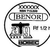
Elle est encadrée en usine par le fabricant dans la moitié supérieure du chant du vantail côté charnières.
