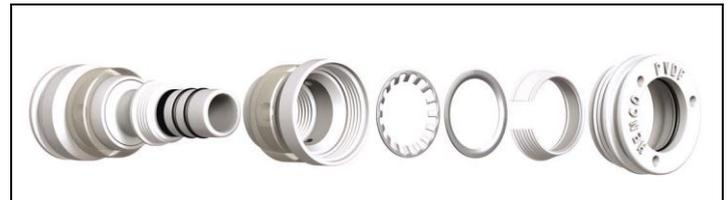
Le corps et la douille de raccord sont livrés prêts à l'emploi, vissés l'un à l'autre, l'ouverture étant obturée par un cache de protection. Pour pouvoir effectuer des réparations ou des remplacements, le corps et la douille de raccord peuvent être dévissés. Dans ce cas, la douille de raccord peut être remplacée en utilisant ce que l'on appelle un «set de réparation». Ce set de réparation se compose d'une nouvelle douille de raccord et de nouvelles bagues d'étanchéité.
