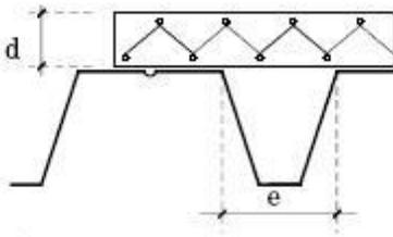
En cas d'utilisation de fixations mécaniques, le schéma de fixation présenté à la figure 1 est renseigné à titre indicatif. Les panneaux isolants sont fixés au moins 4 fois, en respectant la répartition présentée à la figure 1.
