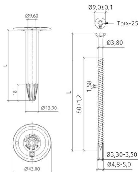
Fig. 3 – Vis GUARDIAN® PS 4,8 + tube GUARDIAN® R(P)45
