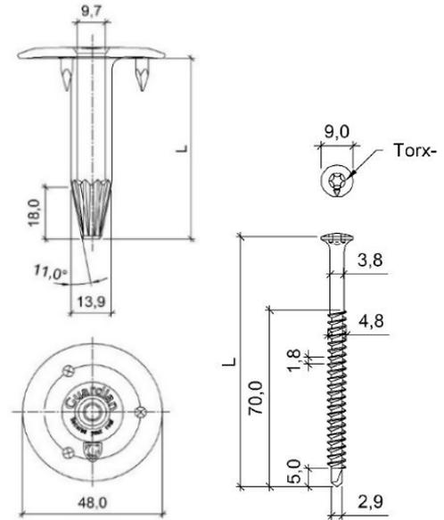
Fig. 5 – Vis GUARDIAN® BS 4,8 + tube GUARDIAN® RB 48
