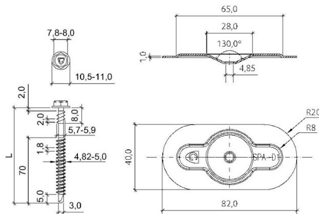
Fig. 2 – vis GUARDIAN® DBT(A) 4,8 + plaquette GUARDIAN® SPA 82x40
