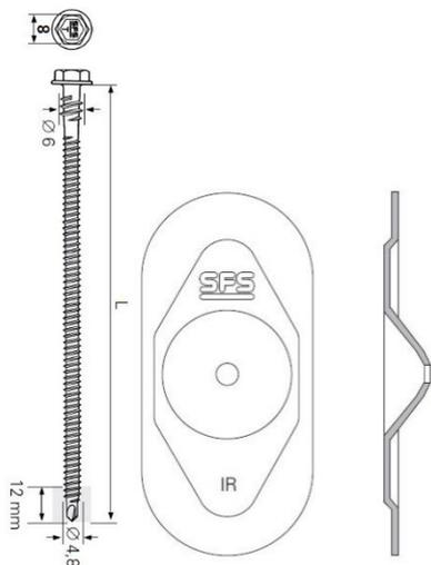
Fig. 1 – Vis IR2(-S) 4,8 + plaquette IR 82x40
