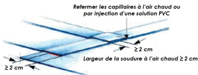
Fig. 8 – Mise en œuvre des joints en T (soudage à l'air chaud)
