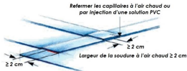
Fig. 1: Mise en œuvre des joints en T
