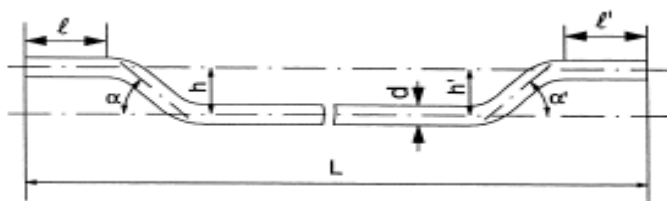
Figuur 2 – Vorm van de haak van de 4D staalvezel
