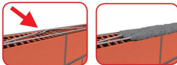
Dans le cas de Murfor®+, les joints longitudinaux à nervures assurent en outre un meilleur ancrage de l'élément d'armature dans le mortier.
