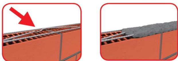
Fig. 6: Écarteurs dans le cas de Murfor® + / Murfor® Spacer
