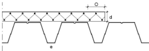
L'ouverture d'onde maximale autorisée (e) est fonction de l'épaisseur de l'isolation :  $e \leq 3 \times d$
