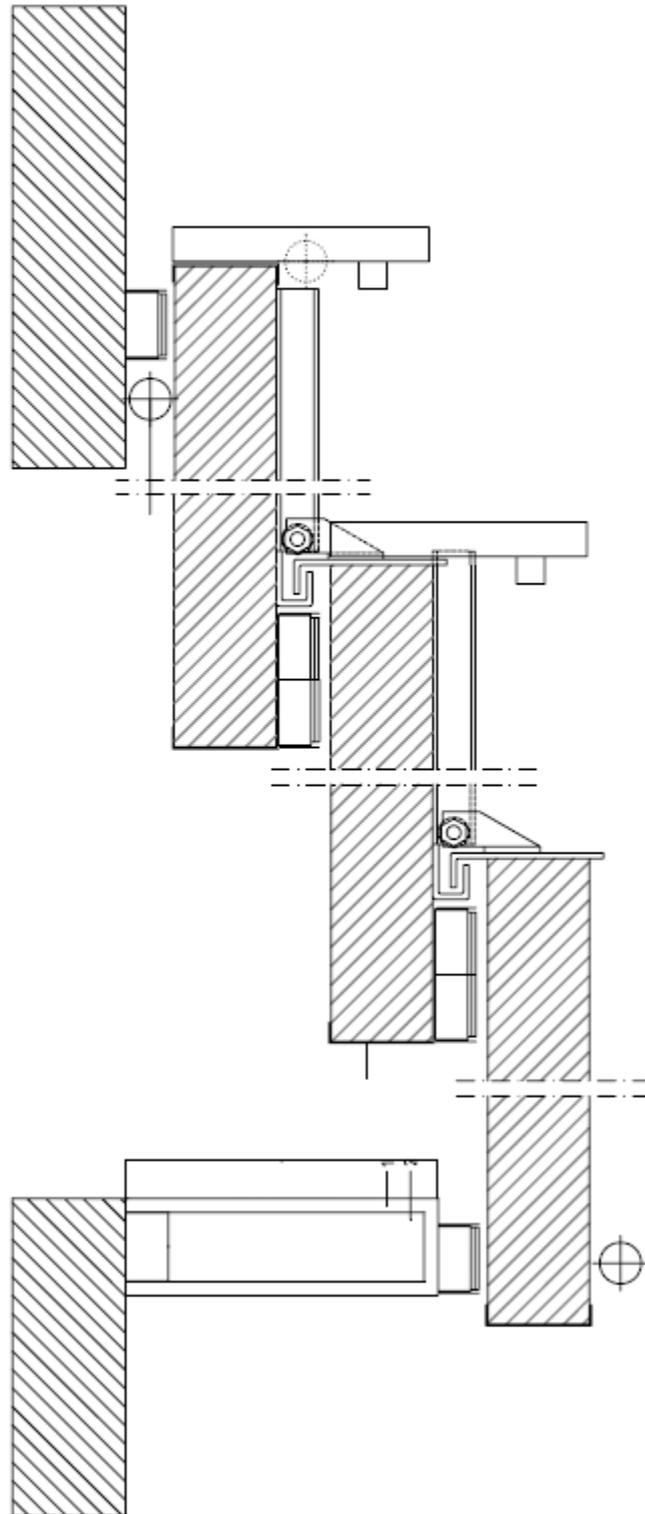
Figure 14 : Mécanisme de suspension et quincaillerie
