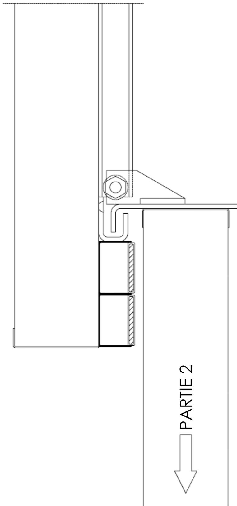
Figure 15 : Mécanisme de suspension et quincaillerie
