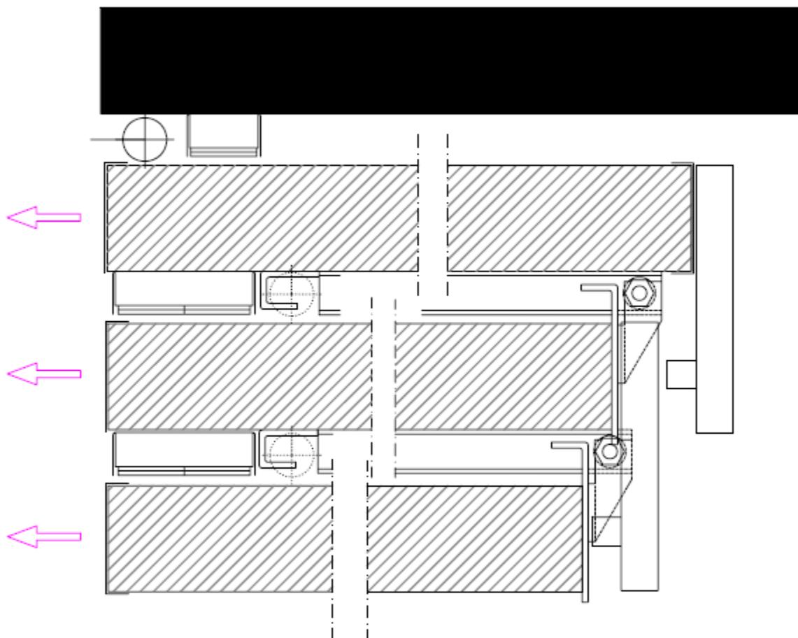
Figure 12 : Mécanisme de suspension et quincaillerie
