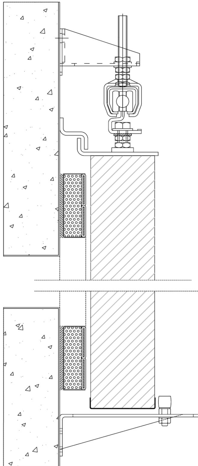
Mécanisme de suspension et quincaillerie
