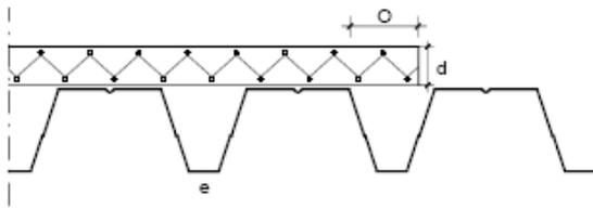
L'ouverture d'onde maximale autorisée (e) dépend de l'épaisseur de l'isolation :  $e \leq 2 \times d$  avec :
