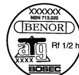
Elle est encadrée en cours de production par le fabricant sur la moitié supérieure du chant étroit du vantail, côté gond.
