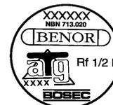
Elle est encadrée en cours de production par le fabricant sur la moitié supérieure du chant du vantail, côté gond.
