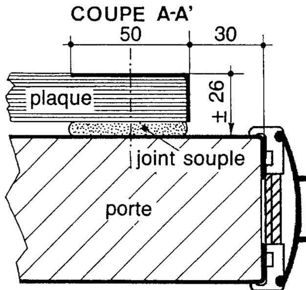
Figure 6 : Coupe horizontale des bourrelets d'une porte double
