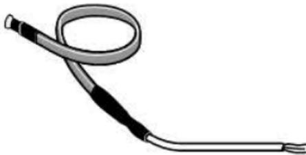
Le ruban chauffant est composé d'une résistance électrique (11,2 W, tension d'alimentation 230 V) qui peut être affixé autour d'un raccord avec une bande adhésive et peut garder l'avaloir à l'abri du gel.
