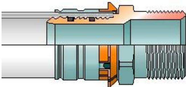
Les raccords à sertir prévus pour les diamètres de 14 mm, 16 mm, 20 mm, 25 mm et 32 mm et les accessoires existant pour cette gamme sont fabriqués à partir de laiton étamé anti-dézincification et font l'objet d'un post-traitement thermique conformément à la NBN EN 12164 et à la NBN EN 12168 (CuZn40Pb2). Les deux bagues d'étanchéité sont fabriquées en EPDM.
