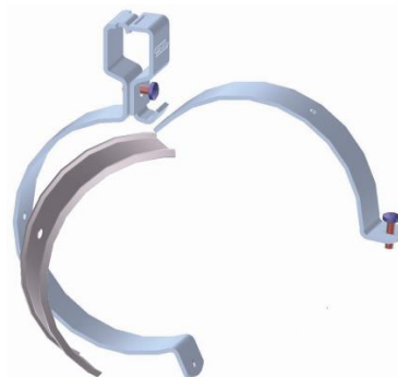
Fig. 4: Schéma collier et demi-coquille métallique
