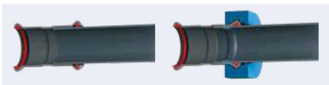
Fig. 1: – coupe transversale avant et après le sertissage
