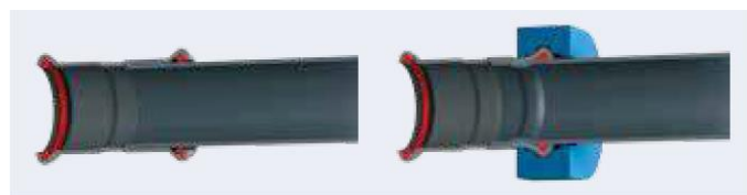
Fig. 1 – coupe transversale avant et après le sertissage
