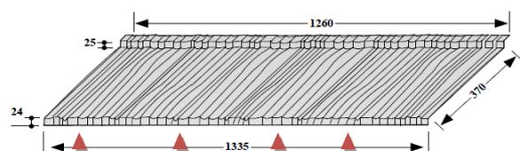
Fig. 23– tuile METROTILE® MISTRAL - pose des fixations
