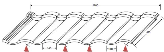
Fig. 21– tuile METROTILE® SHAKE - pose des fixations
