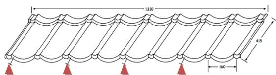
Fig. 20– tuiles METROTILE® ROMAN et METROTILE® ROMANA - pose des fixations
