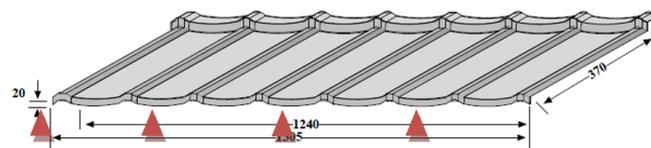
Fig. 24– TUILE METROTILE® ELEGANTA - pose des fixations
