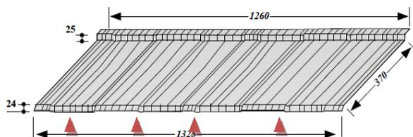
Fig. 22– tuile METROTILE® WOODSHAKE - pose des fixations
