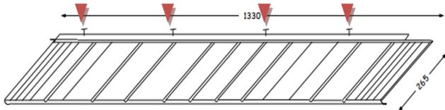
Fig. 30– tuiles METROTILE® I-SHAKE, METROTILE® I-PANEL, METROTILE® I-SLATE et METROTILE® I-SHINGLE - pose des fixations
