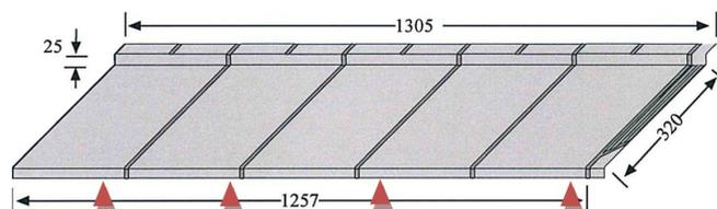
Le clouage s'effectue sur le nez de la tuile métallique, de sorte que le nez de la tuile supérieure soit fixé au talon de la tuile inférieure. On assure ainsi la fixation d'au moins deux éléments au liteau (Fig. 25).
