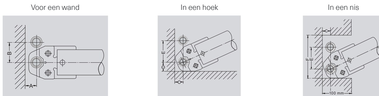
Fig. 4 – benodigde vrije ruimte voor het inpersen
