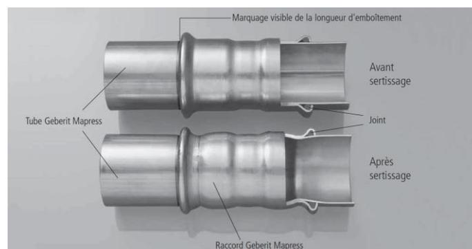
Fig. 1: coupe longitudinale avant et après le sertissage
