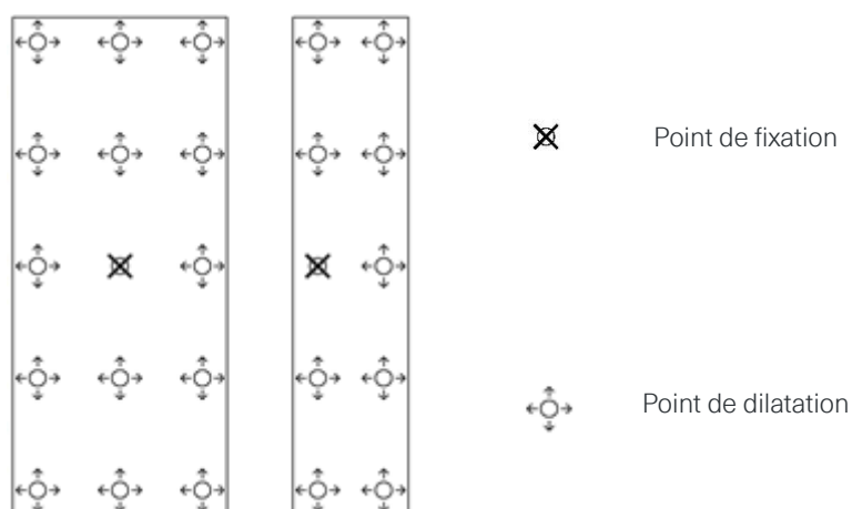
Figure 7 - Principe du point de fixation et point de dilatation
