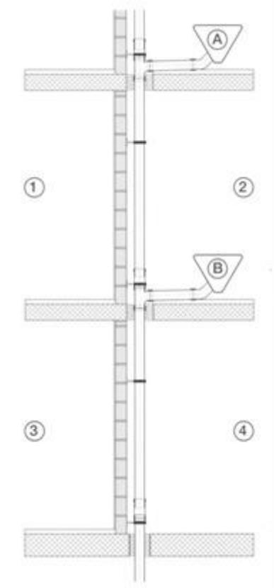
Fig. 1: Configuration pour la mesure des performances acoustiques
