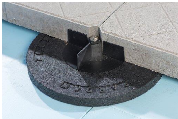
Fig. 1 – Dalle supportée par un répartiteur de pression, un grand CROISILLON et un élément de serrage
