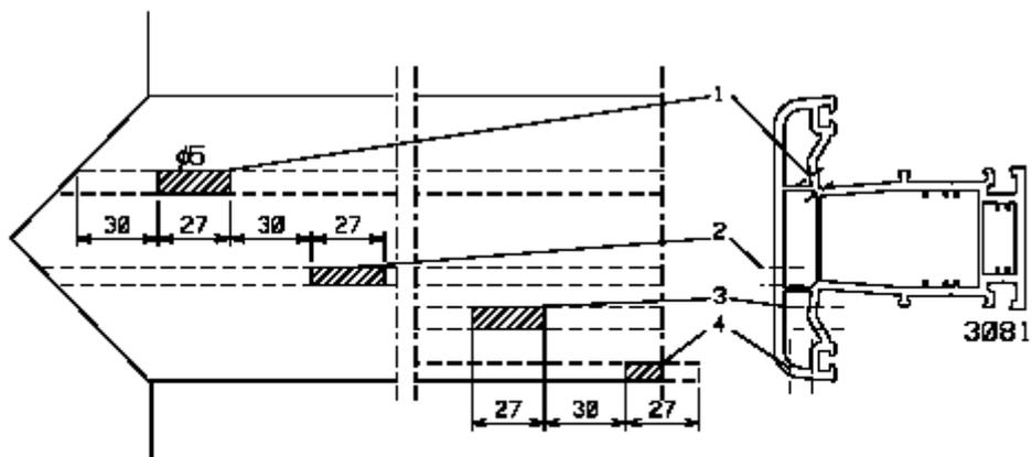
Ou bien, au lieu des boutonnières 3 et 4, au milieu du montant intermédiaire, enlever la lèvre du joint de vitrage ou de frappe (côté extérieur) sur une distance de 30 mm min.
