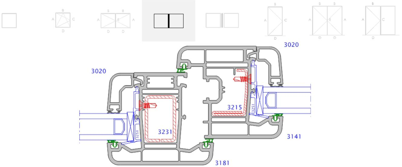
Figure 8: Drainage et décompression
