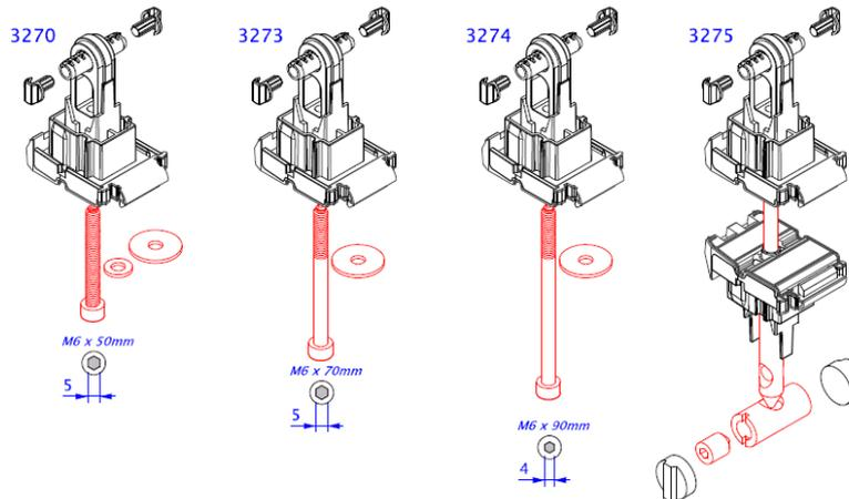
Figure 2e: Assemblage mécanique en T - type Zamak
