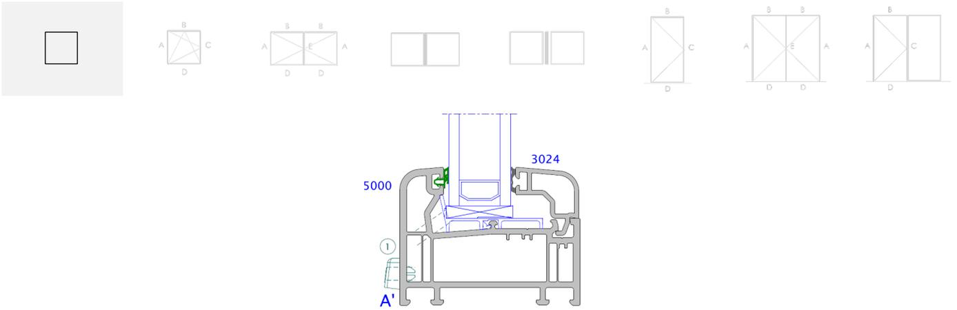
Figure 7b: Coupe-type de fenêtre oscillo-battante
