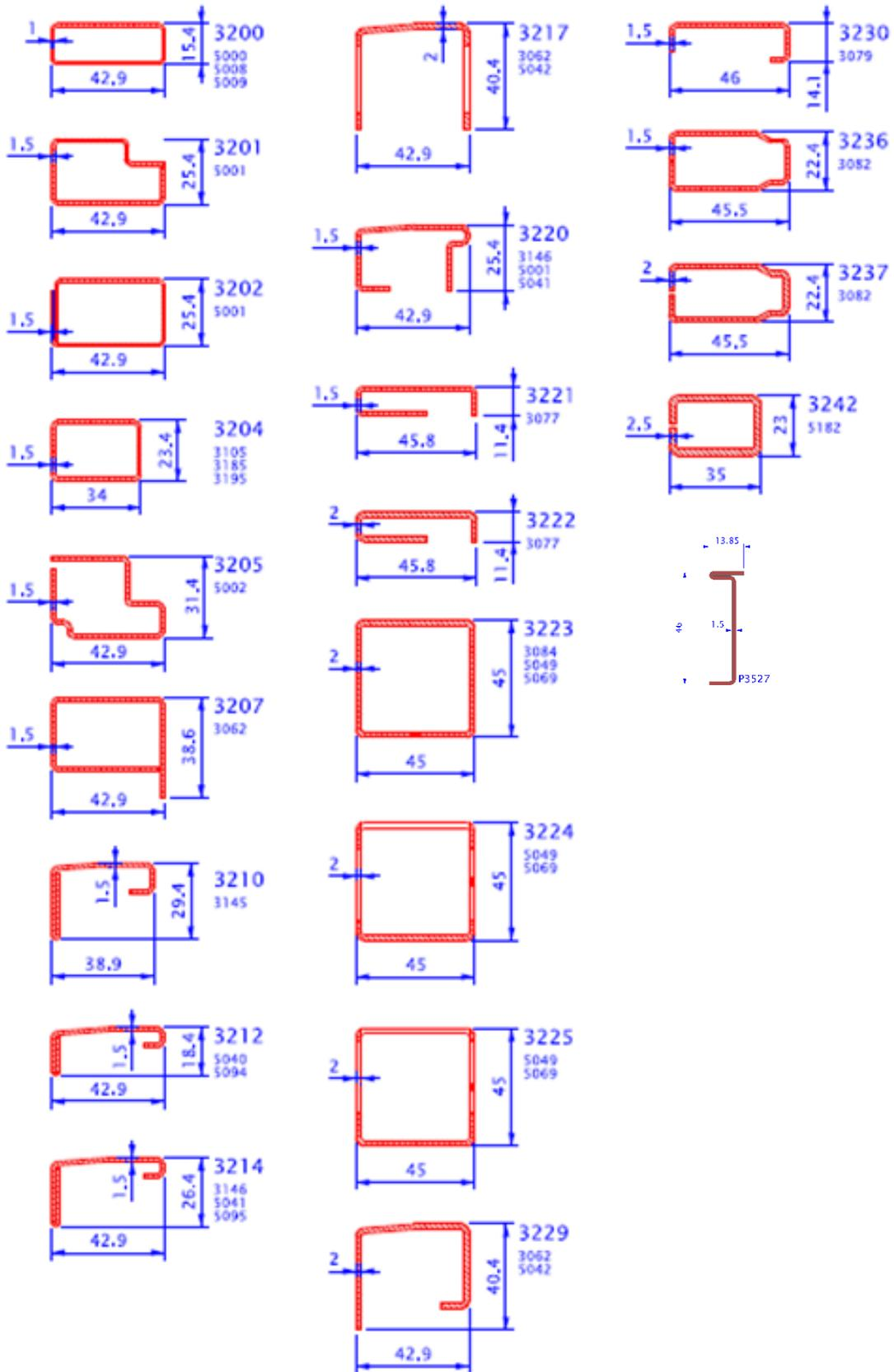
Figure 4: Joints TPE serfi à la machine
