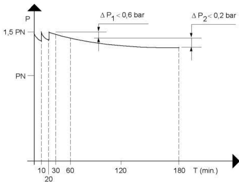
Fig. 3 Procédure du contrôle d'étanchéité
