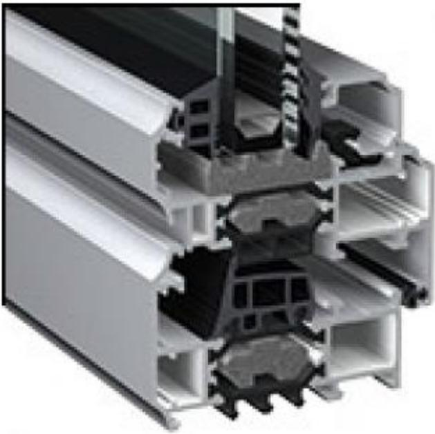
Figure 3 : Coupe-type de fenêtre fixe
