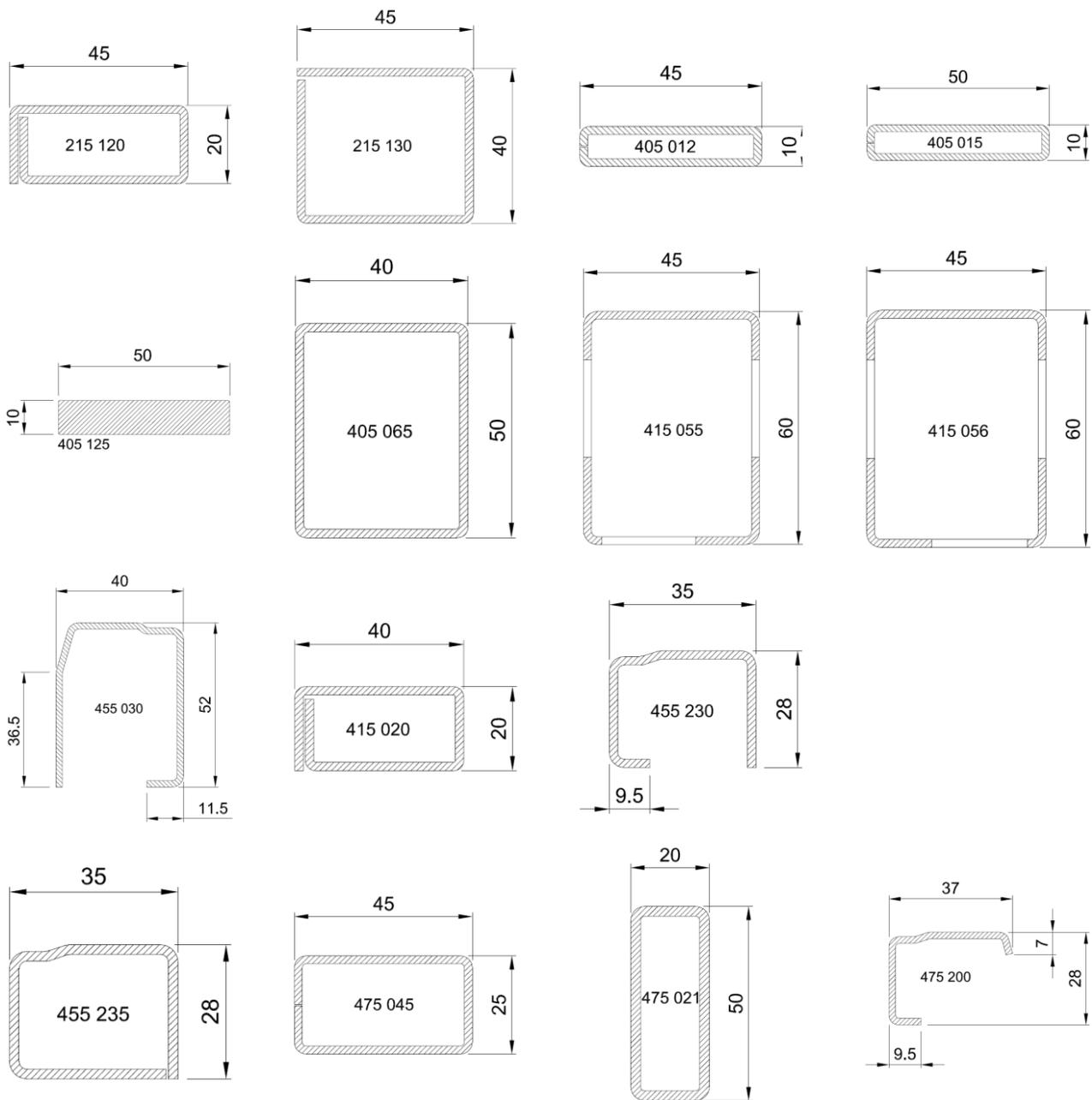
**Figure 4.a: Joints de vitrage extérieurs des vantails**
