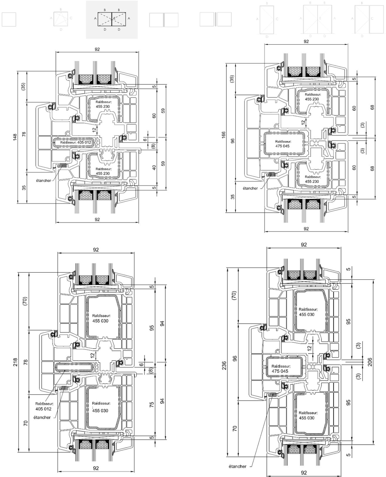
**Figure 8: Drainage et décompression**
