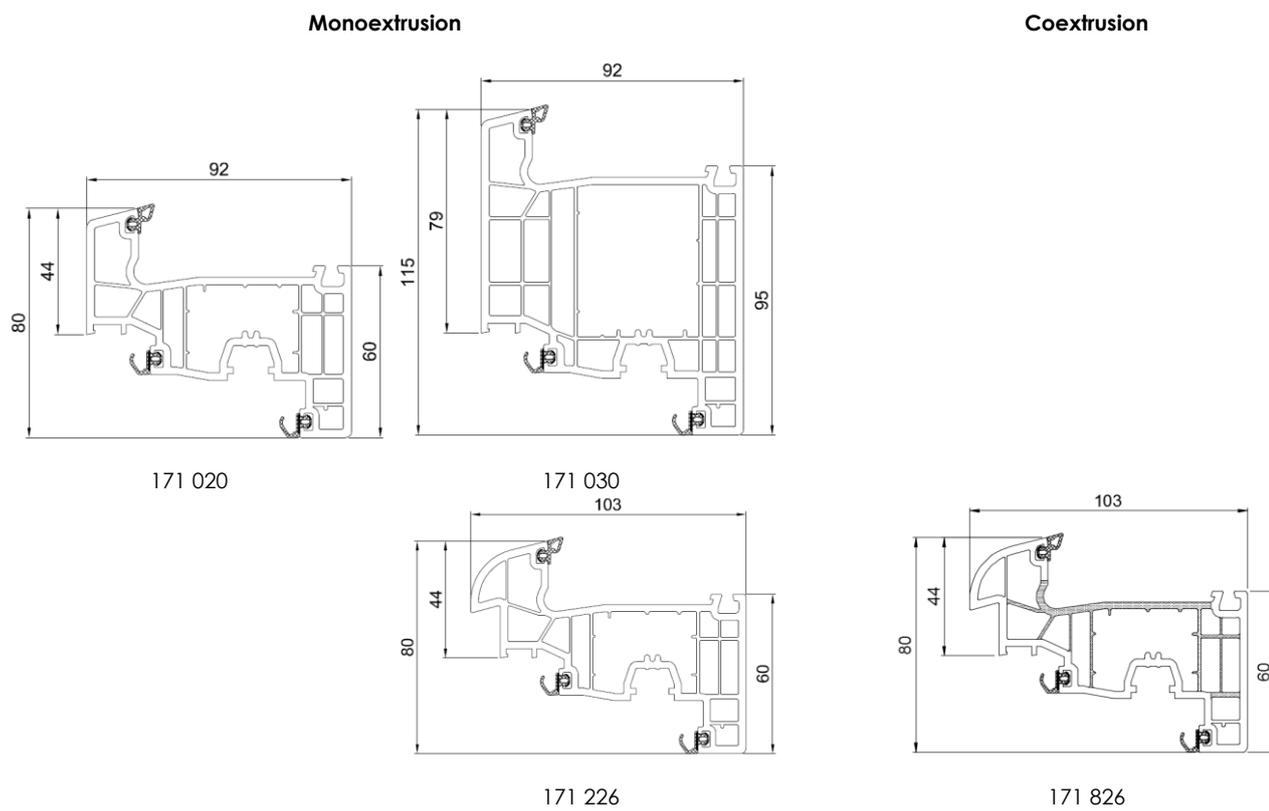
Figure 2c: Montants intermédiaires et traverses
