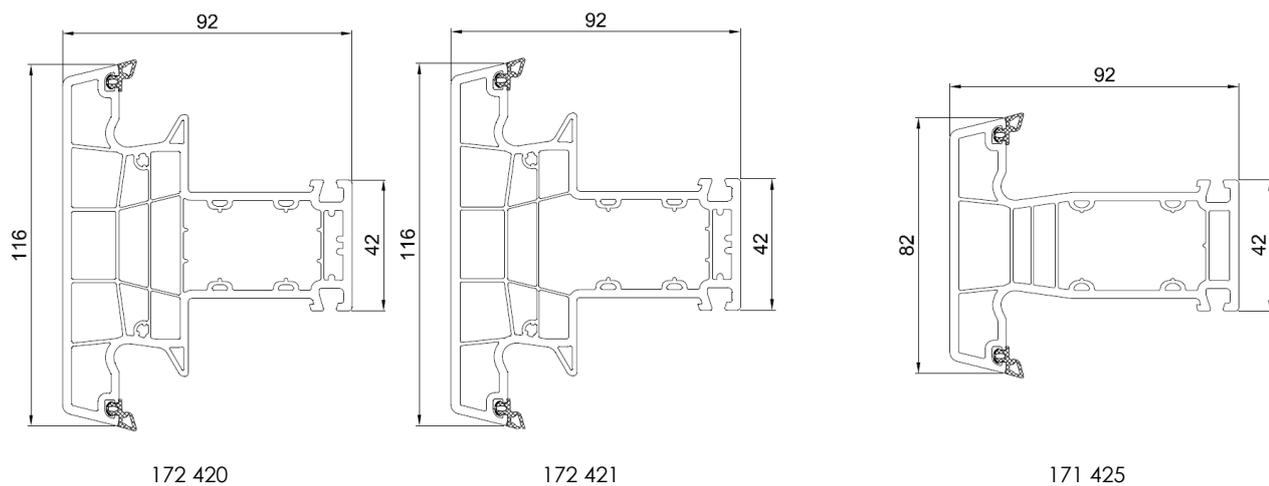
Figure 2d: Assemblage mécanique en T
