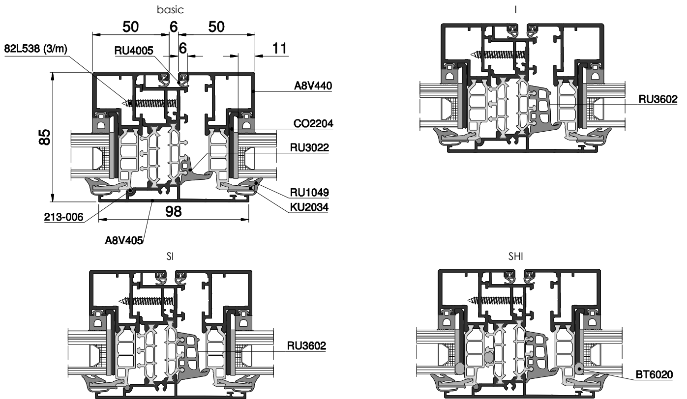
Fig. 13: Coupe de la fenêtre à double ouvrant
