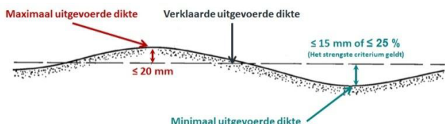
Fig. 1 Bepaling van de verklaarde uitgevoerde dikte
