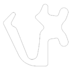
Figure 4.a.1 Joint de frappe intérieur
