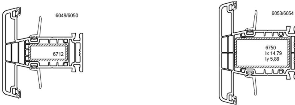
Figure 2d : Assemblage mécanique en T
