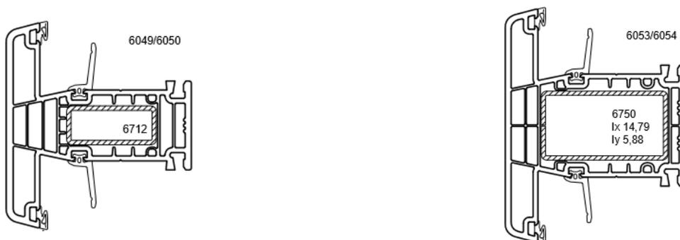
Figure 2d : Assemblage mécanique en T
