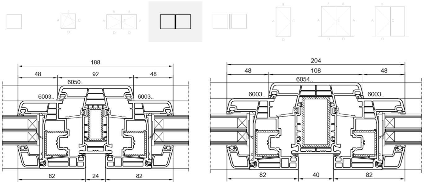
Figure 7e : Coupe-type d'ensemble menuisé
