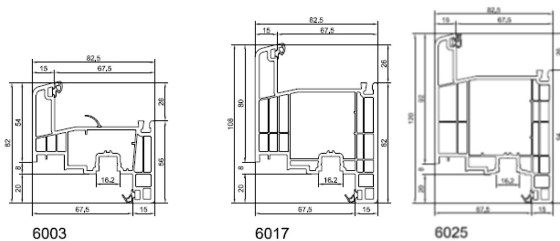
Figure 2c : Montants intermédiaires et traverses
