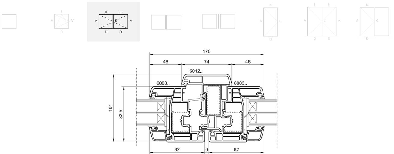
Figure 7d : Coupe-type de fenêtre composée
