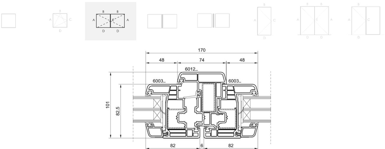
Figure 7d : Coupe-type de fenêtre composée
