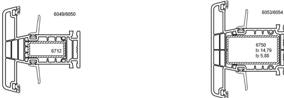
Figure 2d : Assemblage mécanique en T
