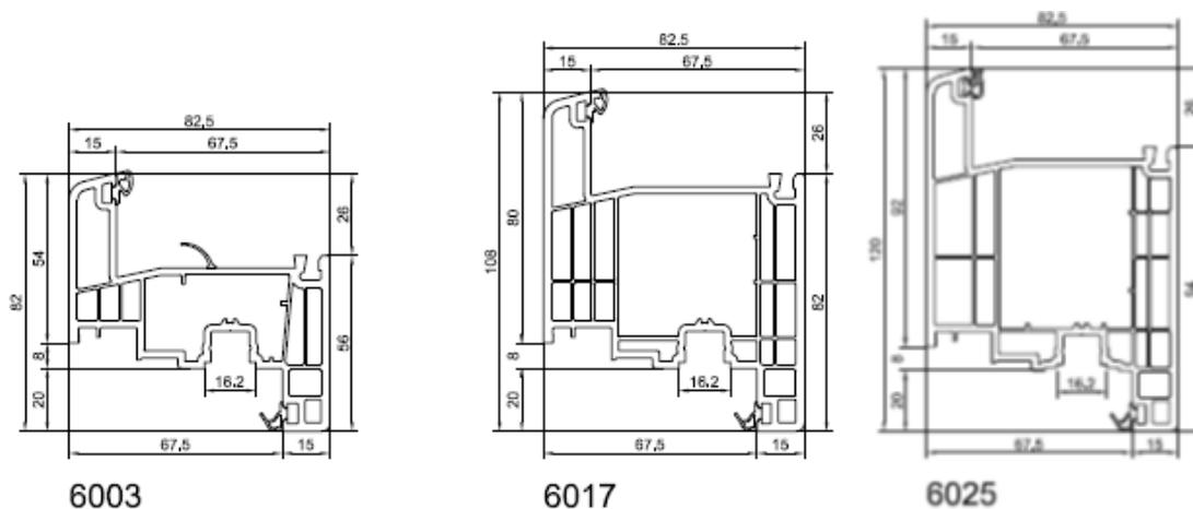
Figure 2c : Montants intermédiaires et traverses
