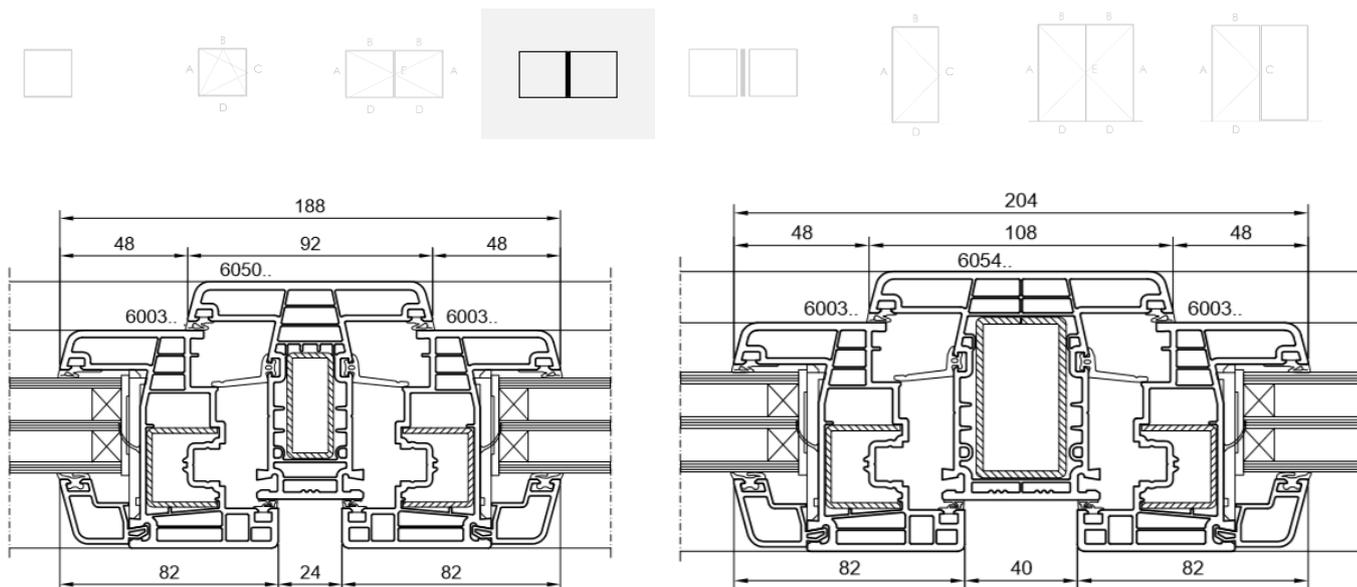
Figure 7e : Coupe-type d'ensemble menuisé
