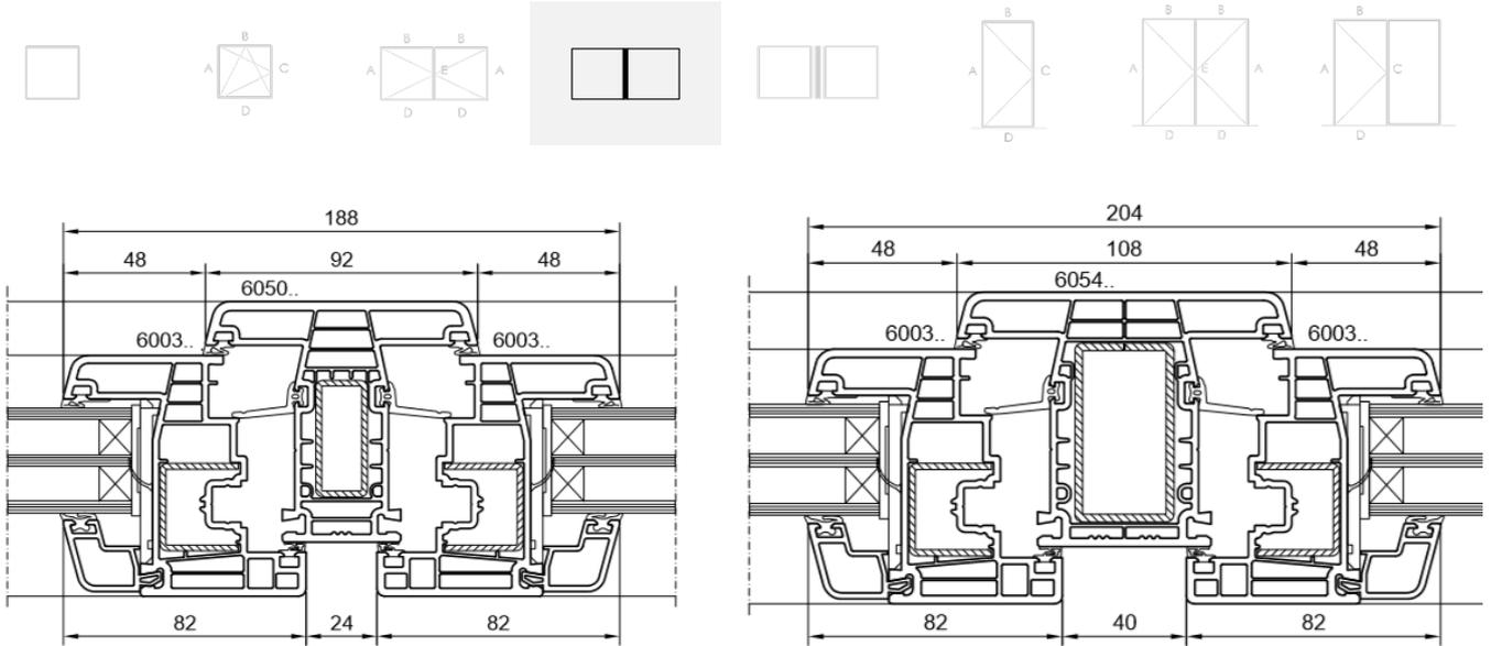
Figure 7e : Coupe-type d'ensemble menuisé
