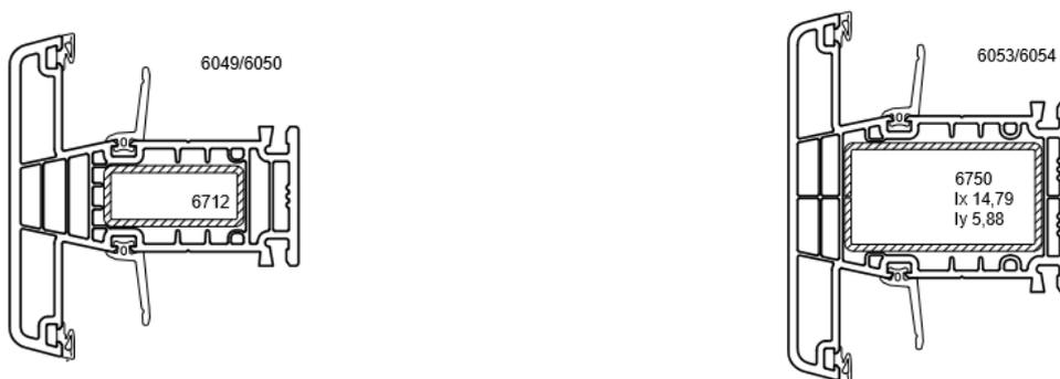
Figure 2d : Assemblage mécanique en T
