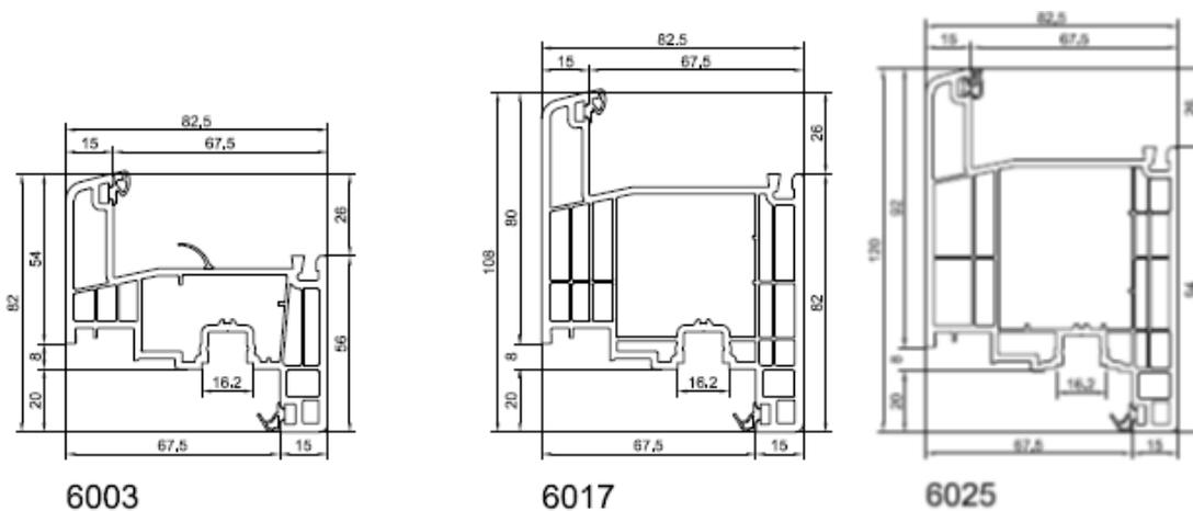
Figure 2c : Montants intermédiaires et traverses
