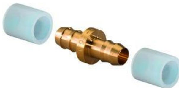
Le tube est fixé sur le corps au moyen d'une bague d'expansion en polyéthylène réticulé, sans utilisation de bagues d'étanchéité. La bague d'expansion est une bague de couleur naturelle, rouge ou bleue en polyéthylène réticulé ; une butée réalisée à l'extrémité du tube (« stop edge ») empêche de glisser la bague d'expansion trop loin sur le tube. La bague d'expansion peut comporter un marquage à l'encre composé du diamètre et de la mention « Q&E ».
