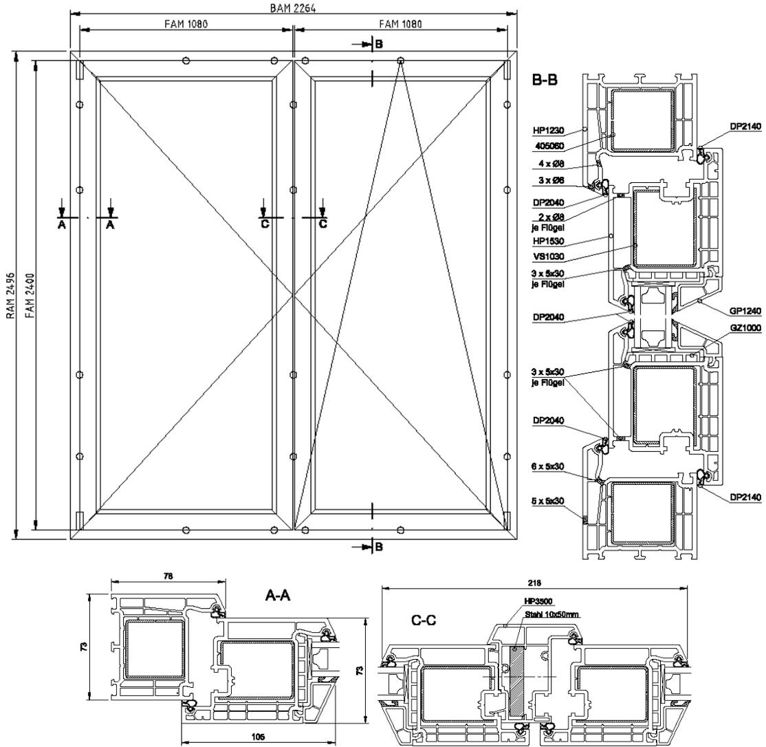
Figure 10 - Coupe de la fenêtre composée
