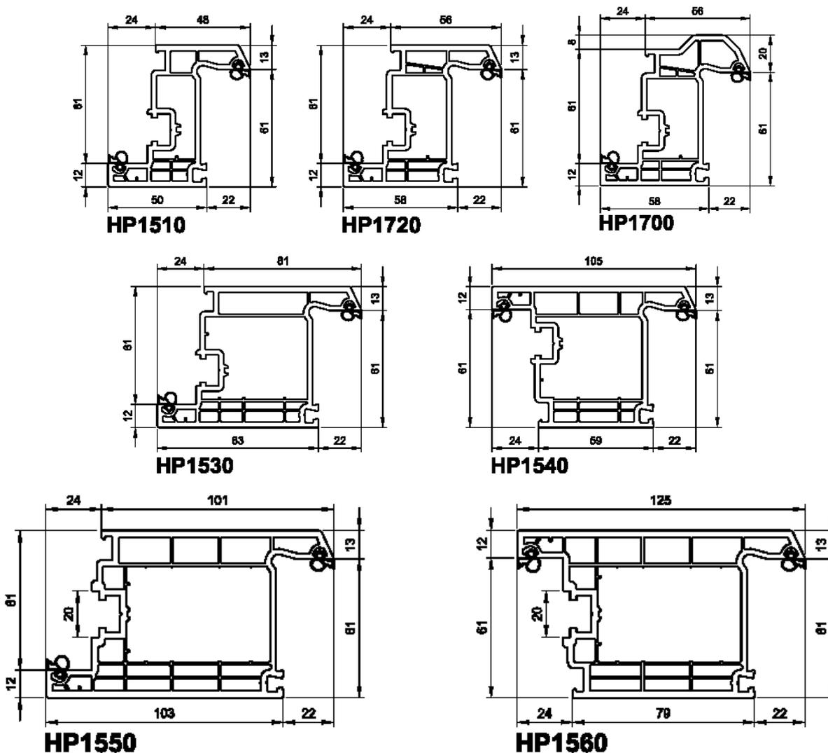
Figure 3 – Profilés de résistance – Montants et traverses (Assemblages en T)
