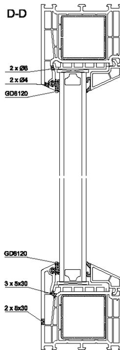
Figure 9 - Coupe de la fenêtre à ouvrant – fenêtre à double vantail SO / fenêtre oscillo-battante
