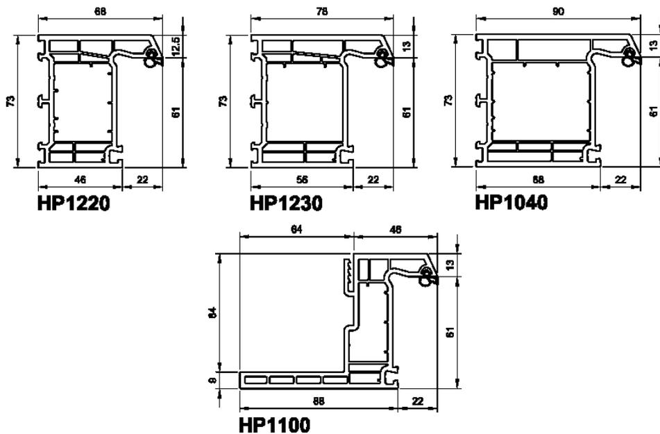
Figure 2 - Profils de résistance - Ouvrant
