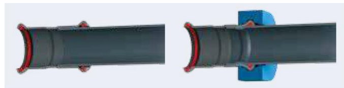
Fig. 1 – coupe transversale avant et après le sertissage
