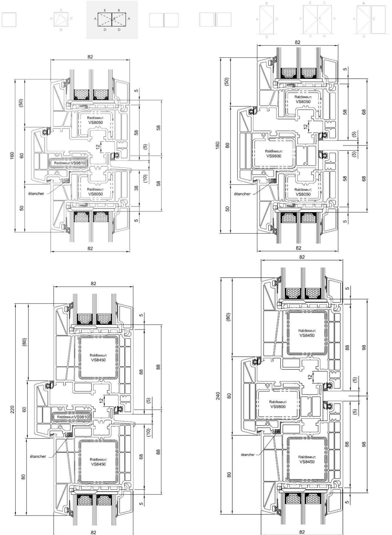
Figure 7d : Coupe-type de fenêtre composée
