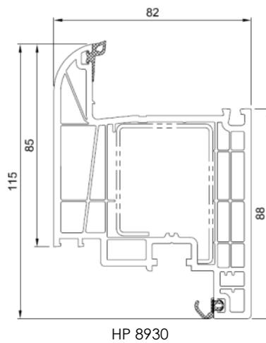
Figure 2c : Montants intermédiaires et traverses
