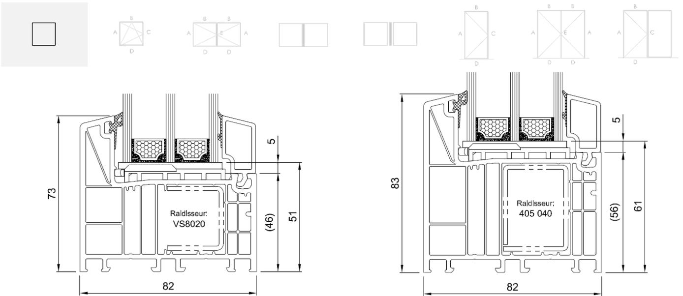
Figure 7b : Coupe-type de fenêtre oscillo-battante
