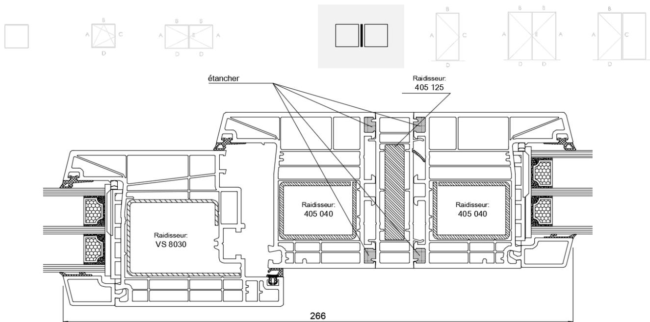
Figure 8 - Drainage et égalisation de la pression
