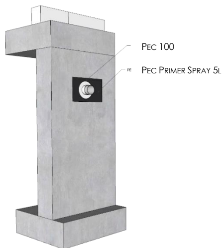
Fig. 10 – Étanchéité à l'eau au niveau des percements dans des éléments en béton
