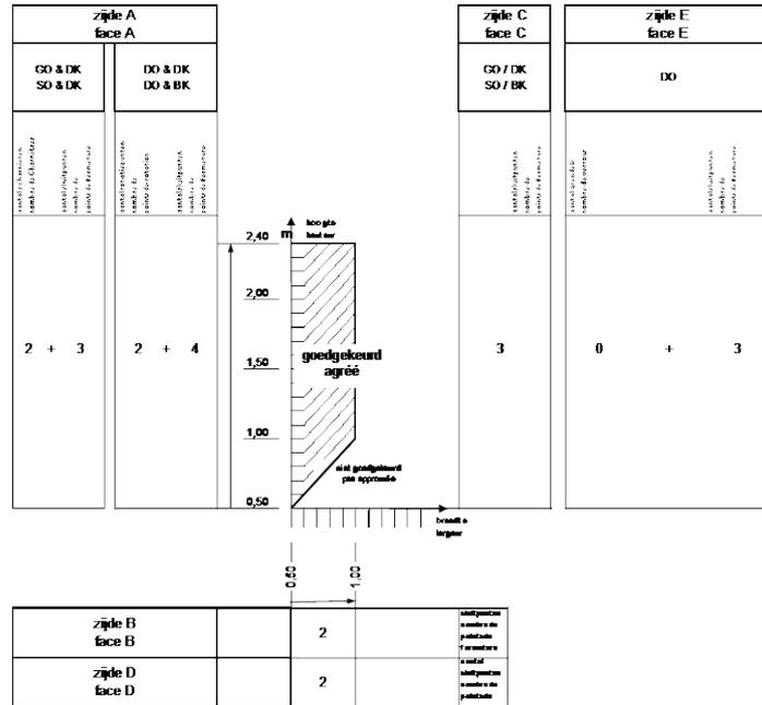
Étanchéité au vent, à l'eau et à l'air du système conformément à la NBN EN 14351-1:2006+A2:2016 à l'aide de rapports d'essai
