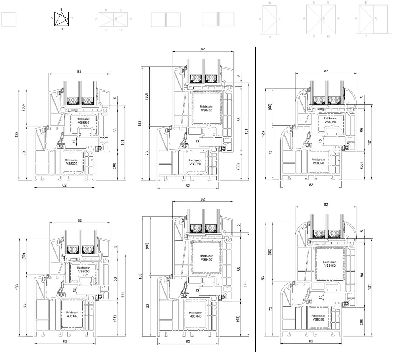
Figure 7c : Coupe-type de fenêtre à double ouvrant avec maucclair
