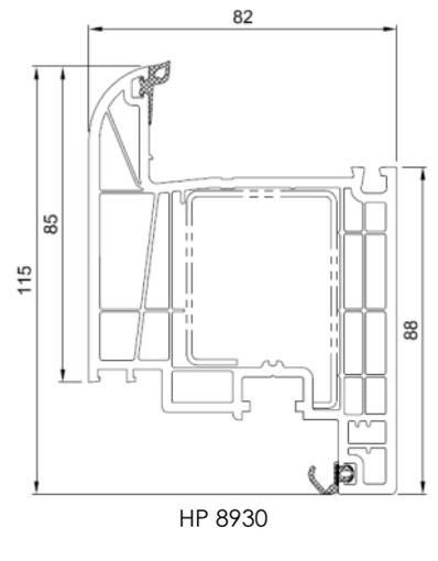
Figure 2c : Montants intermédiaires et traverses
