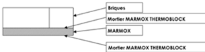
Fig. 3 – Configuration de l'essai de compression combinant les élément Marmox THERMOBLOCK® et des briques de terre cuite
