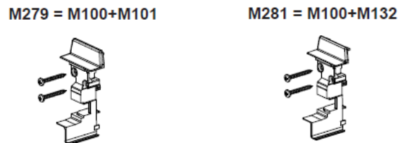
Figuur 6.b: Eindstukken voor makelaar 76401 voorzien van aluminium voorzetschaal
