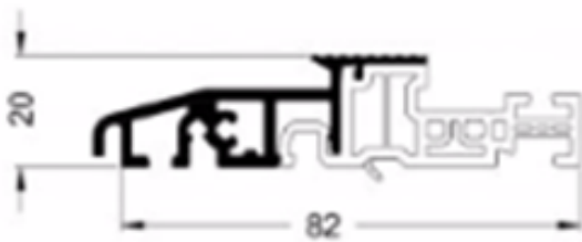
Figuur 5.c: Aanvullende profielen gecombineerd Aluminium/PVC - deurdorpels
